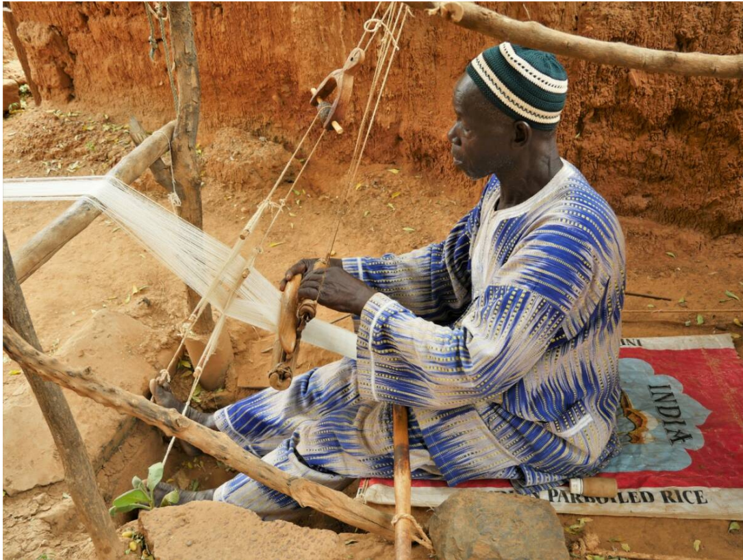
Fig.1 : Tisserand mossi sur le métier traditionnel en bois à lisses suspendues et à pédales, Kaya 2018. Photo Laura Fortin.
